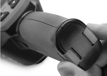
Figure 3 – Couvercle du logement de piles
